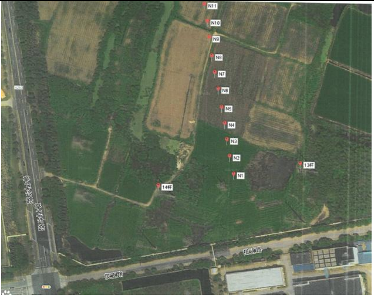
图 4.4-1 亭合线 2A87/2A88、合林 1S003/合亭 7654 同塔四回线路噪声监测示意图
