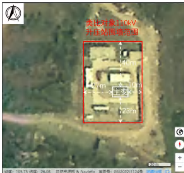
图 3.1-1 类比升压站距围墙距离示意图
