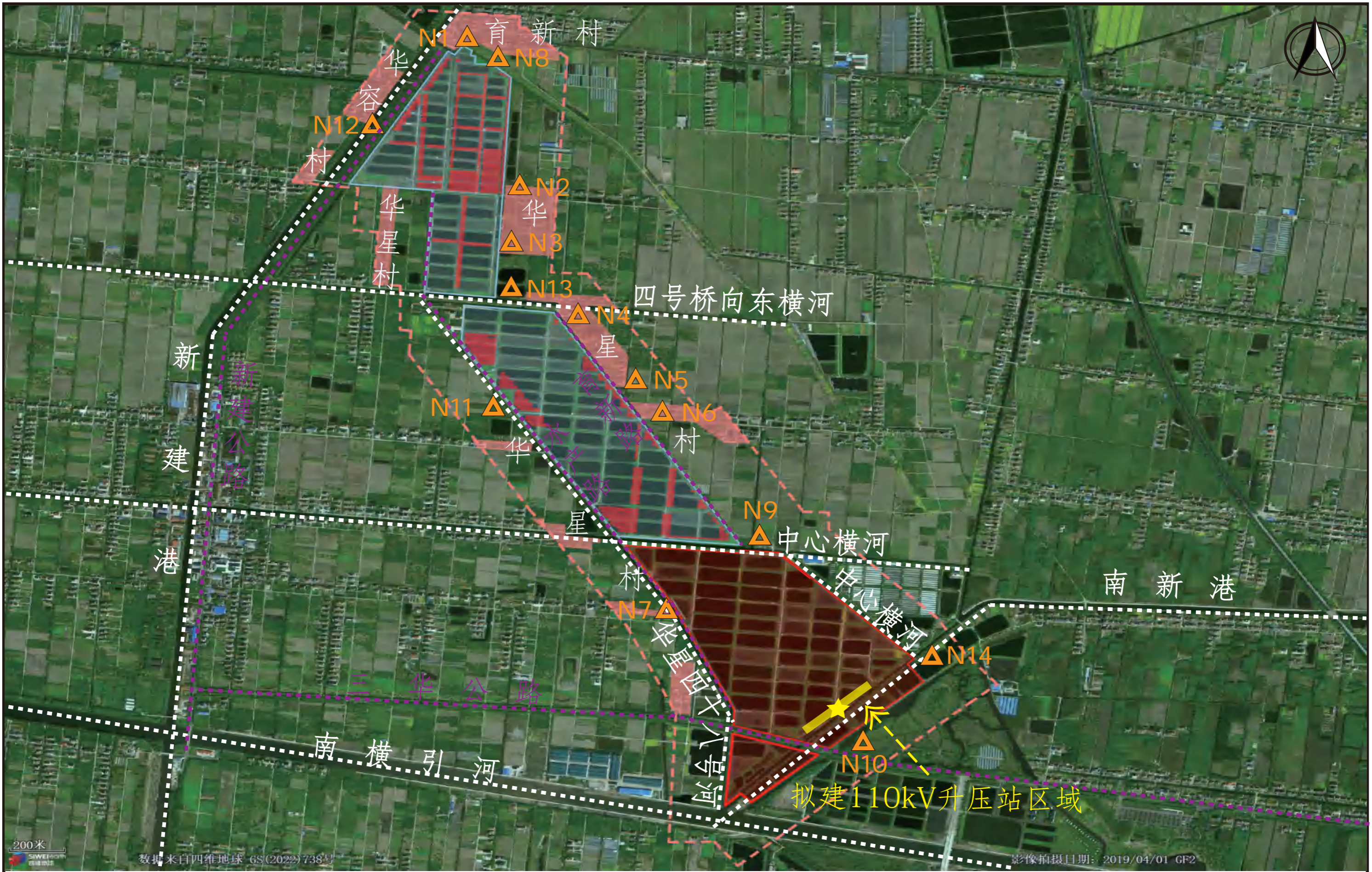
■ 上海华电崇明华星81MW渔光互补光伏发电项目 (892亩新租赁地块) ■ 华电崇明绿华44MW渔光互补光伏发电项目占地范围 上海华电崇明华星81MW渔光互补光伏发电项目 (220亩依托绿华项目地块) 声环境评价范围 (本项目占地边界外扩200m) 声环境保护目标 ★ 电磁环境监测点位 ▲ 声环境监测点位 附图2-1 项目声环境评价范围、声环境保护目标及现状监测点位示意图
