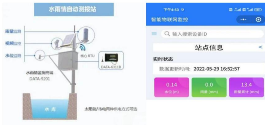
图 5.5-22 智能化自动监测水位系统
