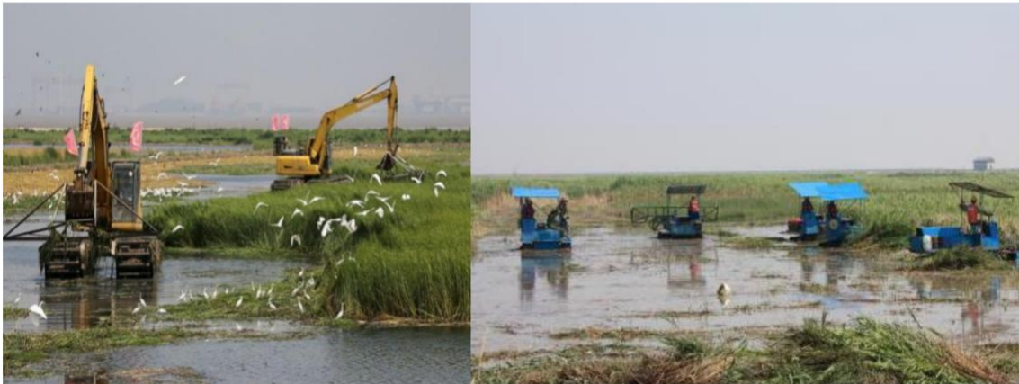
图 5.5-16 机械刈割及带水刈割设备示意图
