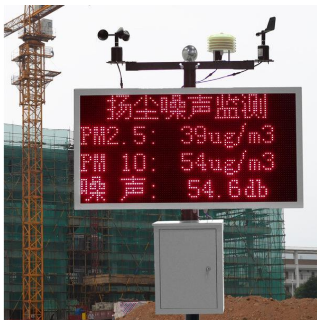
图 7.3-2 工地扬尘在线监测系统
