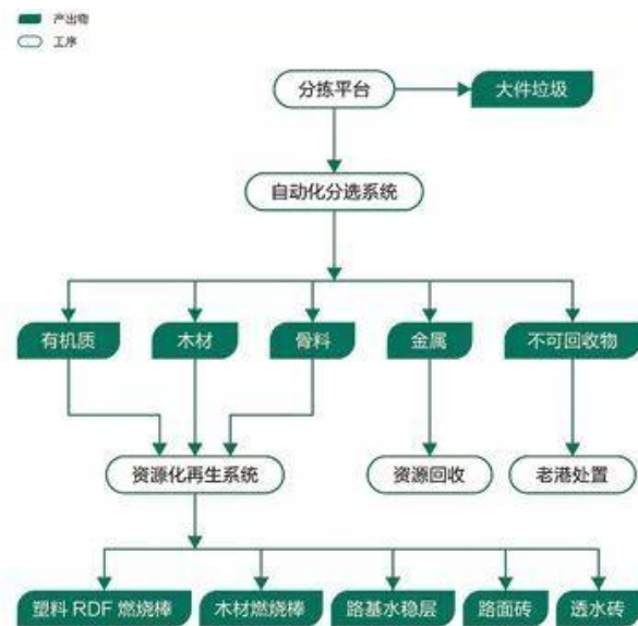
图 10.4-2 建筑垃圾资源化利用过程
